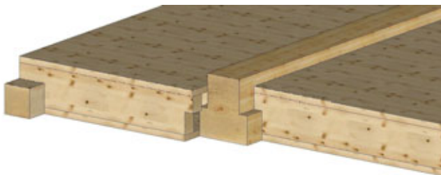
ELEMENT PLACEMENT ON A WOODEN PROFILED BEAM Colocación del elemento encima de un prisma de madera perfilado
