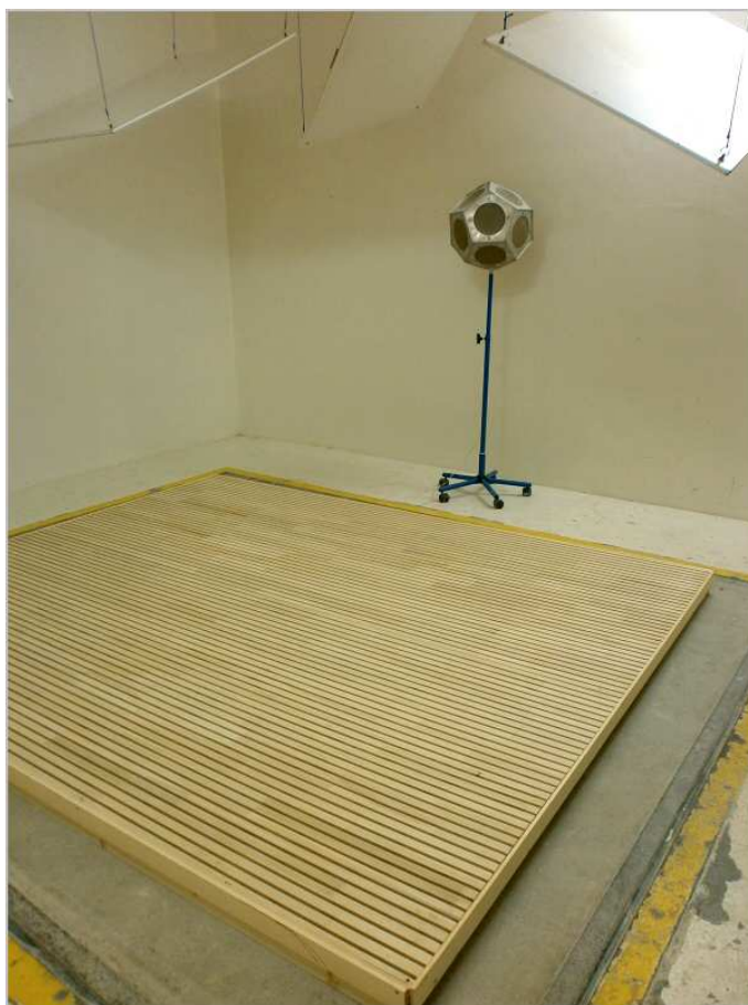
Zkušební vzorek v dozvukové místnosti
