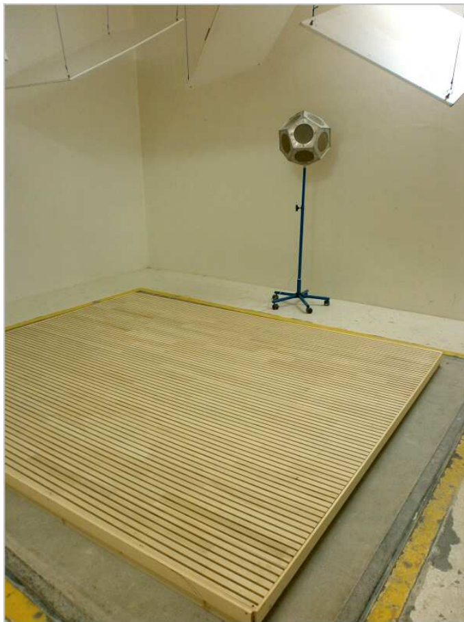
Zkušební vzorek v dozvukové místnosti
